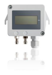
DS01 + 系列微处理器控制的压力变送器适用于测量非腐蚀性气体的正压、负压和差压。压力测量通过压阻式半导体传感器实现。根据型号不同,DS01 + 可测量 2.5 hPa 至 100 hPa 的压力。该压力变送器有两种基本版本,其测量范围可通过 DIP 开关在四个区间内切换。DS01 + 不仅在测量范围上为用户提供了最大灵活性,还可根据应用需求轻松调整输出信号和时间常数,无需复杂的重新调试。其轻巧紧凑的结构堪称空间优化的典范,特别适合在狭窄空间内进行低压测量。无磨损的测量系统几乎无需维护。如需校正测量值,可轻松调整零点和幅值。可选配 LCD 显示屏,通过简单的插拔系统即可加装。
