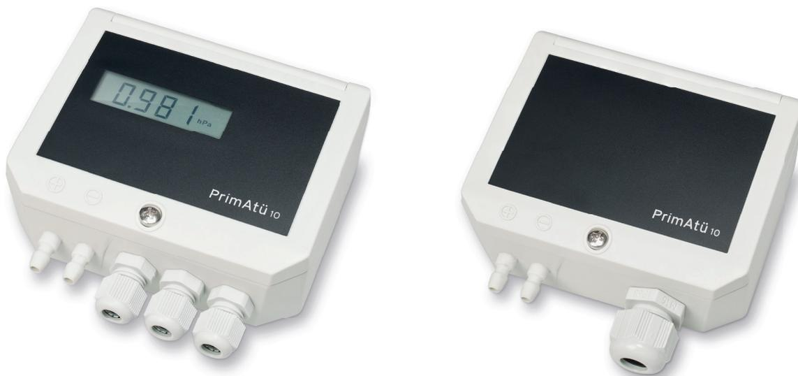
通过 PrimAtü 10 压力变送器，根据所选测量范围，可检测并显示正负压差，直至最小压力范围。压力测量通过压阻式硅传感器实现，该传感器将检测到的压差转换为与压力成比例的输出信号。输出选项可选择光学显示的显示屏或数字接口。根据型号不同，变送器可采用 24 VDC/VAC 或 230 VAC 电源供电。显示和通过接口输出的压力单位可在 hPa、Pa、mbar 和 psi 之间选择。压力变送器可通过两个按钮进行校准：一个按钮用于零点校准，另一个用于幅度校准。
